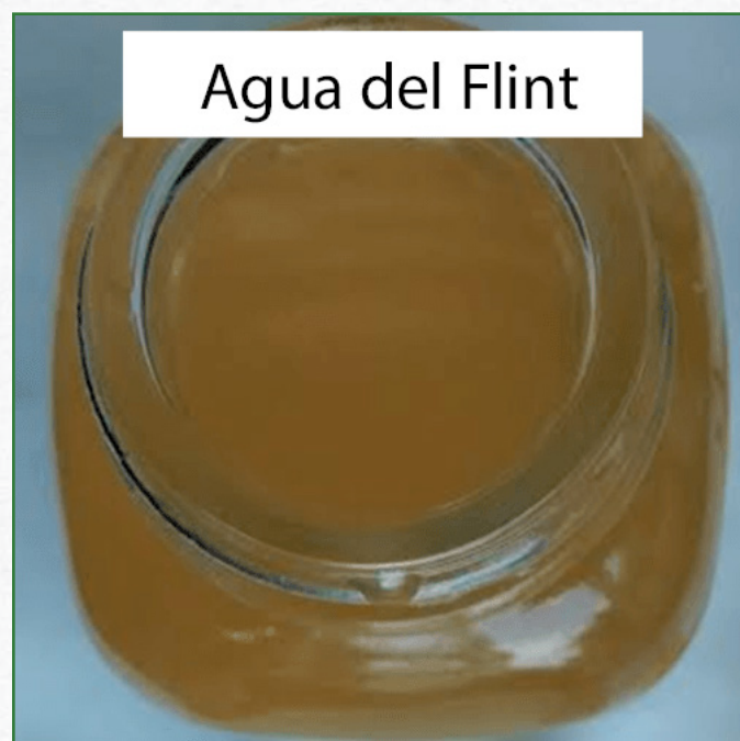
FIGURA A.24 : LA CORROSIÓN DEL HIERRO CAUSA AGUA “ROJA” U OXIDADA
