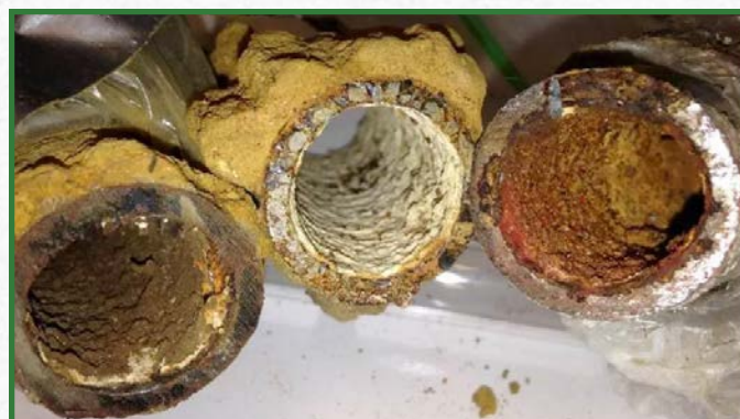
FIGURE A.25 : ÉCHANTILLONS DE TUYAUX EN FONTE CORRODÉS EN PROVENANCE DE FLINT, AU MICHIGAN
