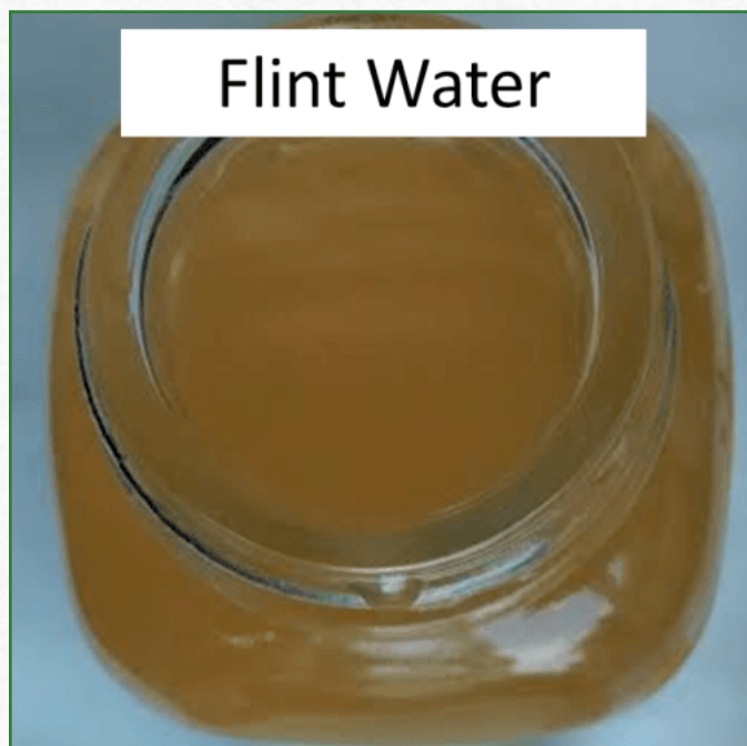
FIGURE A.24 : LA CORROSION DU FER DONNE À L'EAU UNE COULEUR ROUGE/ROUILLÉE
